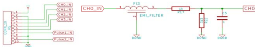
Fig. 3.2 Diseño electrónico entrada analógica.
