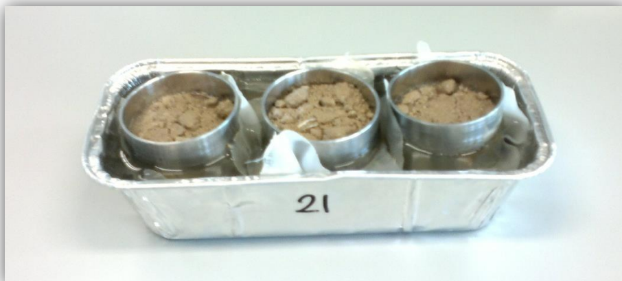
Figura 4.14. Medida de la capacidad de campo.
