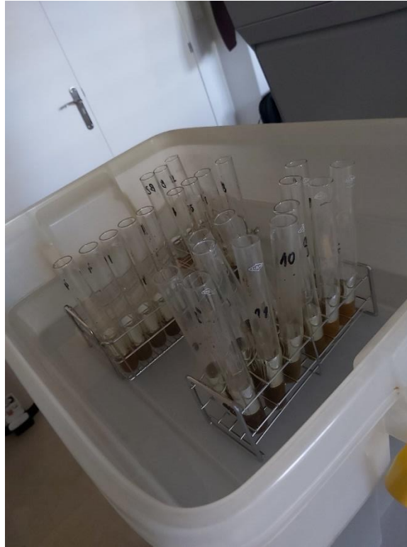
Ilustración 5: Tubos de ensayo sumergidos en agua para su enfriamiento tras la digestión en la determinación de materia orgánica
