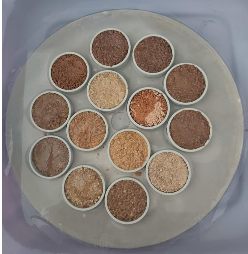
Ilustración 10: Muestras en el proceso de humectación para el cálculo del punto de marchitez permanente
