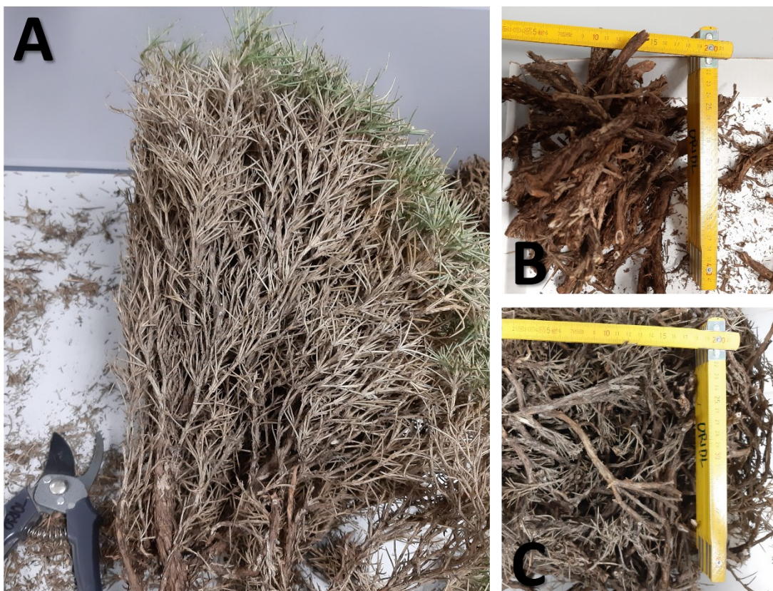
Figura 3. Procedimiento del fraccionamiento de la biomasa de erizón. A: mata de erizón antes del fraccionamiento; B y C: resultado del fraccionamiento.
