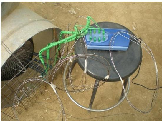
Fotografía 4: Detalle del "Data Logger" y los termopares.
