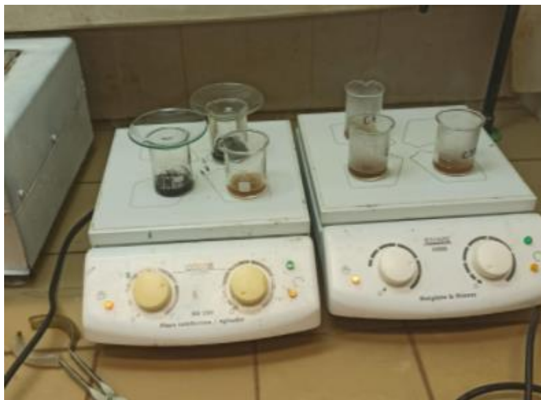
Figura 6. Residuo mineral tras la calcinación del material vegetal sobre la placa calefactora.
