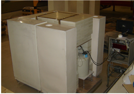
Figura 4.10: La fotografía de la izquierda muestra la instalación del blindaje antineutrones con tanques de agua borada. La gráfica de la derecha muestra la evolución temporal del ritmo de sucesos en la región de baja energía del espectro (4-10 keV). Se observa una reducción de éste tras la instalación (línea discontinua vertical) de los tanques de agua borada. Las líneas horizontales representan el valor medio del ritmo antes y después de la instalación del blindaje antineutrones.
