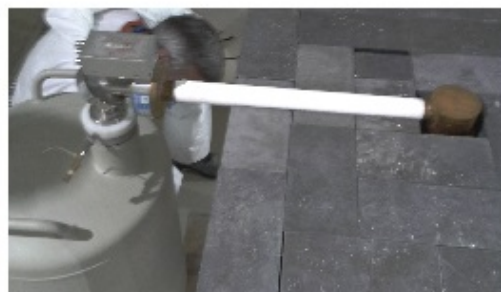
Figura 2.1: En el esquema de la izquierda se muestra el principio de funcionamiento de un detector semiconductor. En la imagen de la derecha se muestra el enfriamiento de un detector de germanio poniéndolo en contacto térmico con el nitrógeno líquido almacenado en un dewar.
