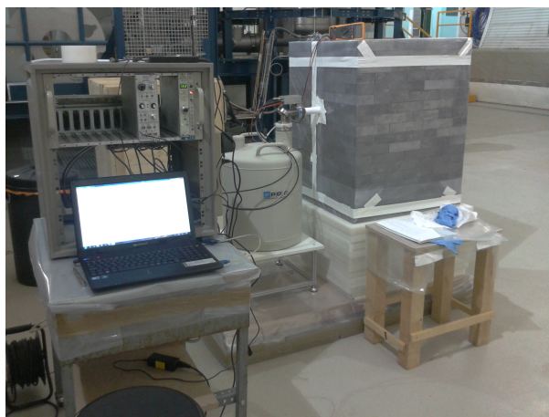
Figura 4.1: Instalación del detector COSME en el hall A del LSC.
