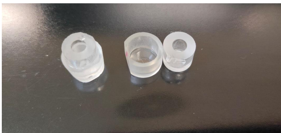
Figura 7. Portamuestras utilizado en los ensayos del TMA.
