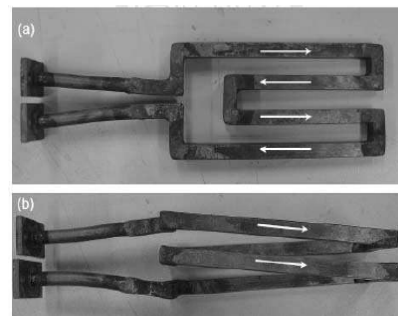
Figura 10. Bobinas con corrientes en sentido opuesto (a) o idéntico (b). (9)
