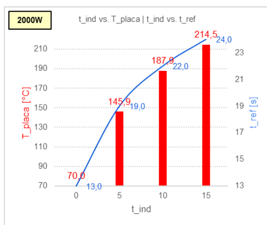
Figura 26. Relación entre el tiempo de calentamiento y la temperatura de la placa y tiempo de refrigeración para 2000W.
