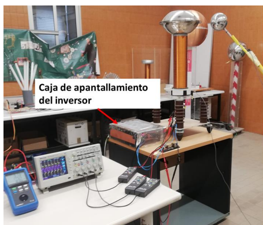
Ilustración 38 Montaje para los ensayos sobre la bobina de Tesla. En la figura de la izquierda se observa el montaje utilizado. A la derecha se observa un arco eléctrico generado a 149kHz.
