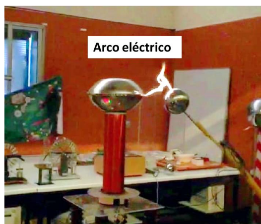
Ilustración 38 Montaje para los ensayos sobre la bobina de Tesla. En la figura de la izquierda se observa el montaje utilizado. A la derecha se observa un arco eléctrico generado a 149kHz.
