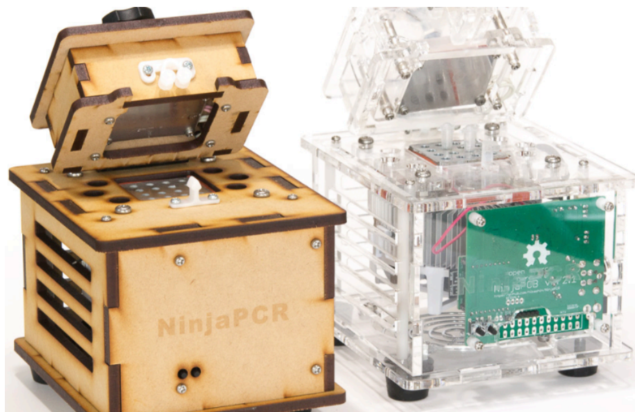
Figura 1.5. Equipo open-source de partida Ninja PCR [8]
