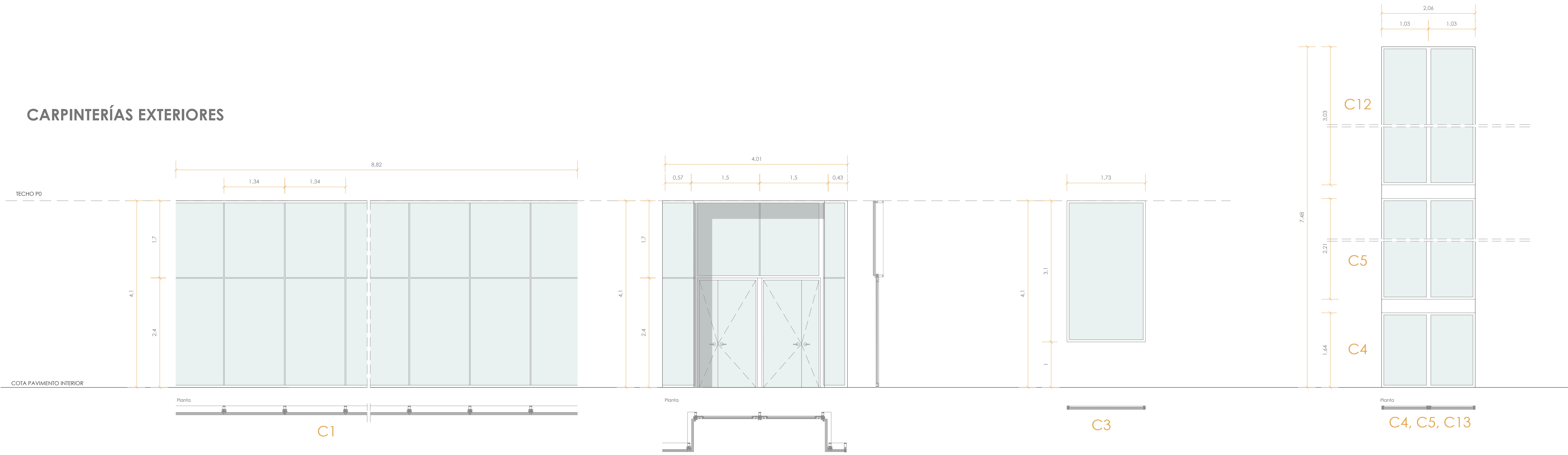
C4 C5 C13 CARPINTERÍA ESCALERAS ADMINISTRACIÓN U = 0.8 W/m²K R w = 46 dB
