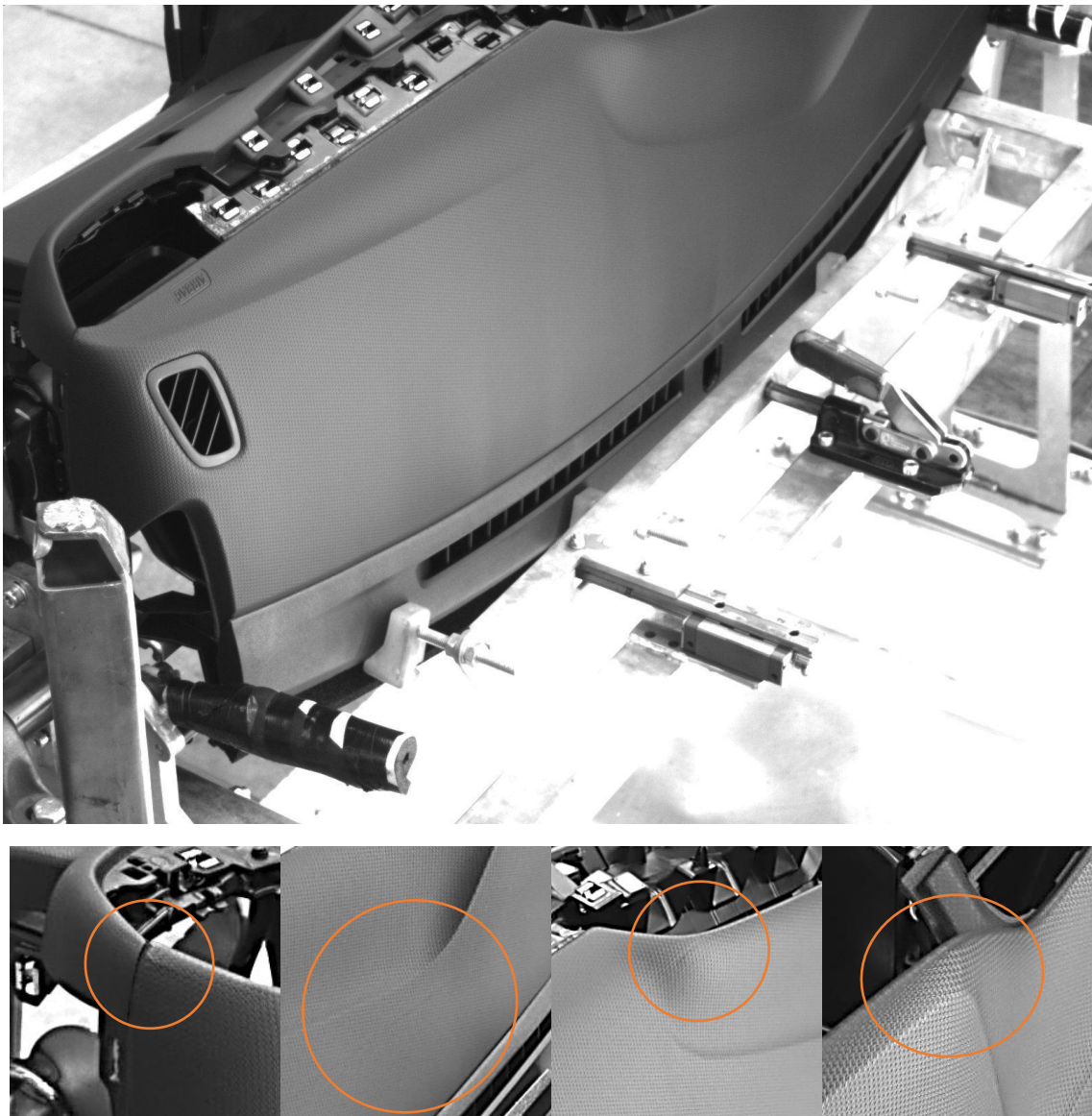
Figura 4.2.2. Imágenes de defectos capturados desde la configuración B: (a) arruga; (b) raya-1; (c) raya-2; (d) bollo. Fuente Propia.
