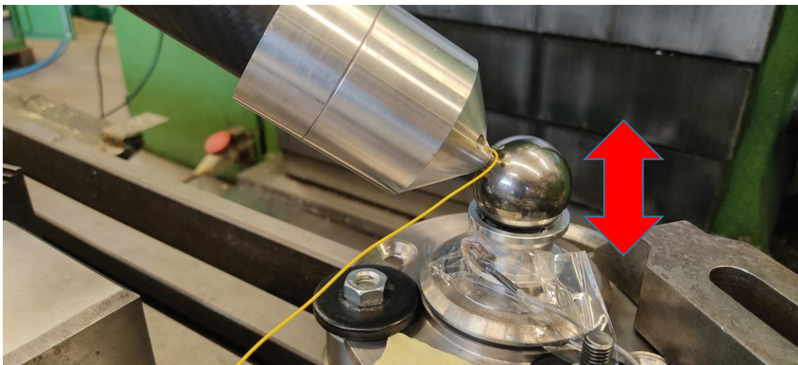
Ilustración 34. Esquema del ensayo en bancada de quitar la esfera
