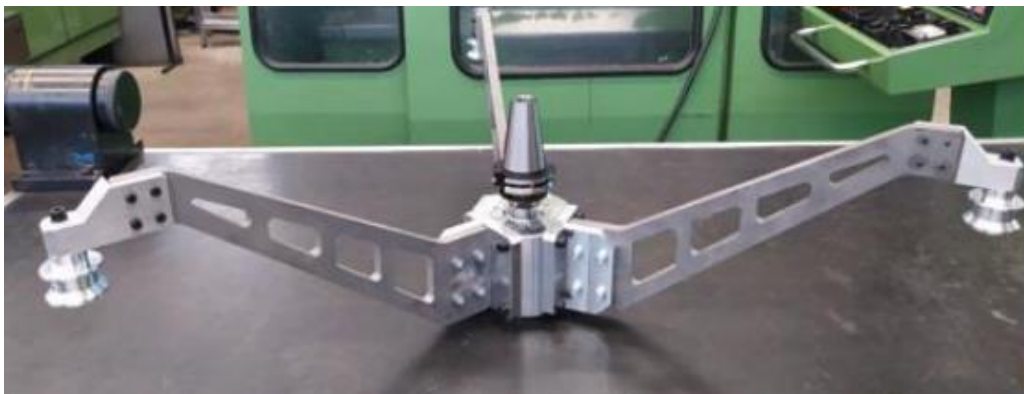
Ilustración 13. Utillaje para mh "estrella" [10]
