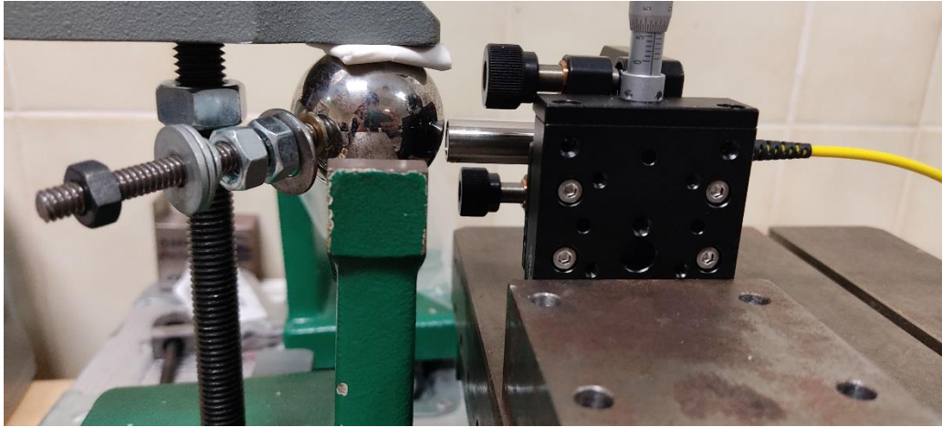
Ilustración 18. Utillaje para medición de calidad con esfera
