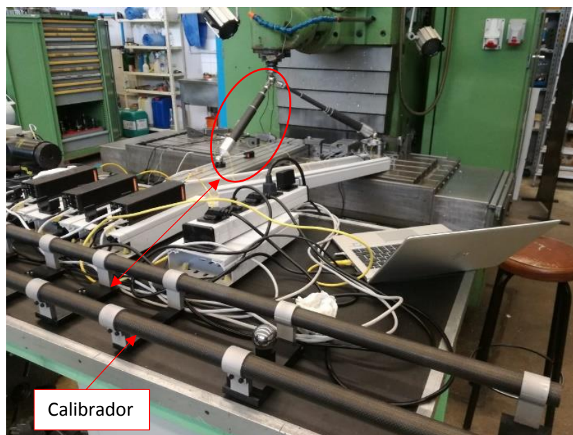
Ilustración 30. Sistema de medición con el calibrador
