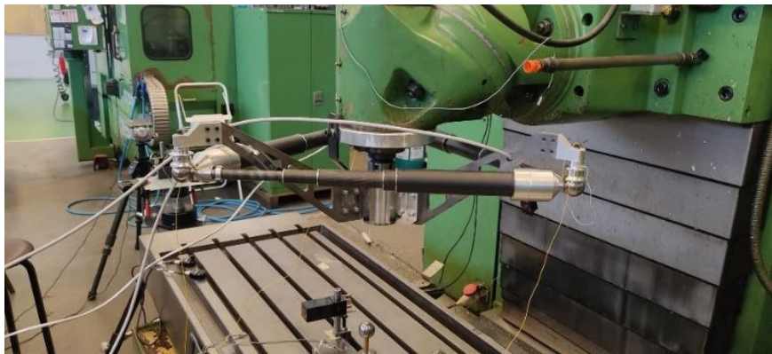
Ilustración 15. Medición de distancia entre bases. Disposición en bancada (Arriba). Disposición en estrella (Abajo)
