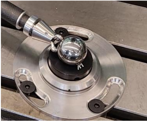
Ilustración 11. Sujeción en la bancada de la máquina herramienta [8]
