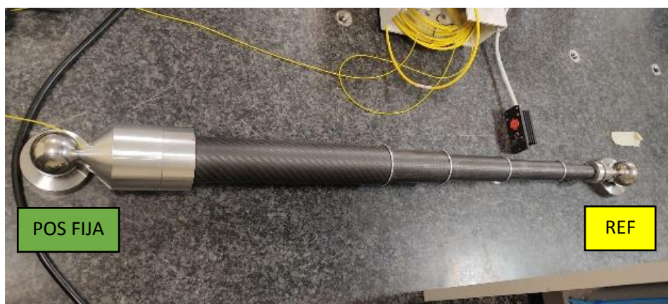
Ilustración 19. Colocación del brazo en el ensayo para evaluar los modos de medida
