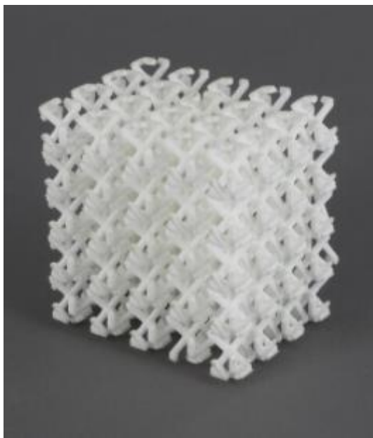
Ilustración 2. Pieza impresa en SLS. Fuente: Treatstock
