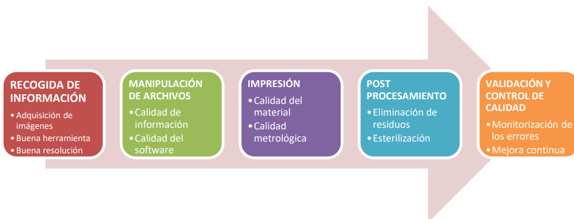
Ilustración 5. flujo de trabajo en la impresión 3D hospitalaria. Fuente: 3D Printing In Hospitals: A Beginner's Guide, 2020. Elaboración propia.
