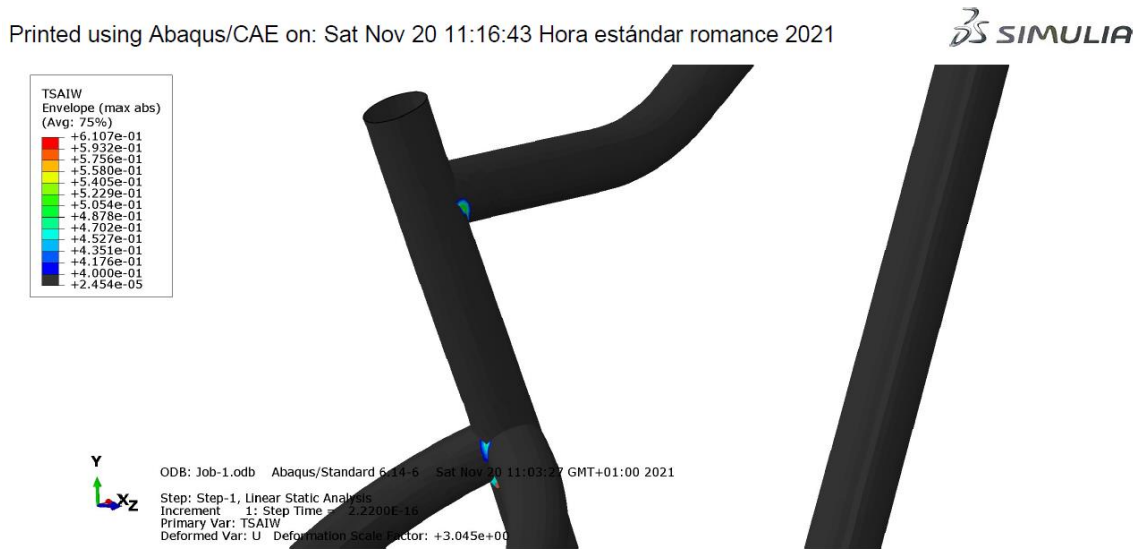
Figura 92. Criterio de fallo Tsai Wu (mayores a 0,4 excluyendo vainas), Step 2, Abaqus.
