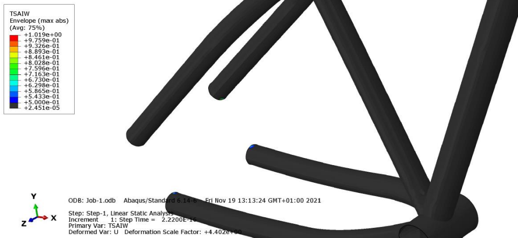
Figura 76. Criterio de fallo de Tsai Wu (valores mayores a 0,5), Step 2, Abaqus.
