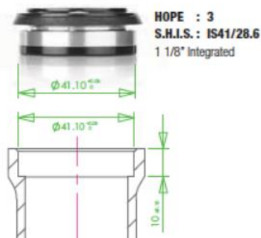
Figura 15. Dirección embutida integrada [4].
