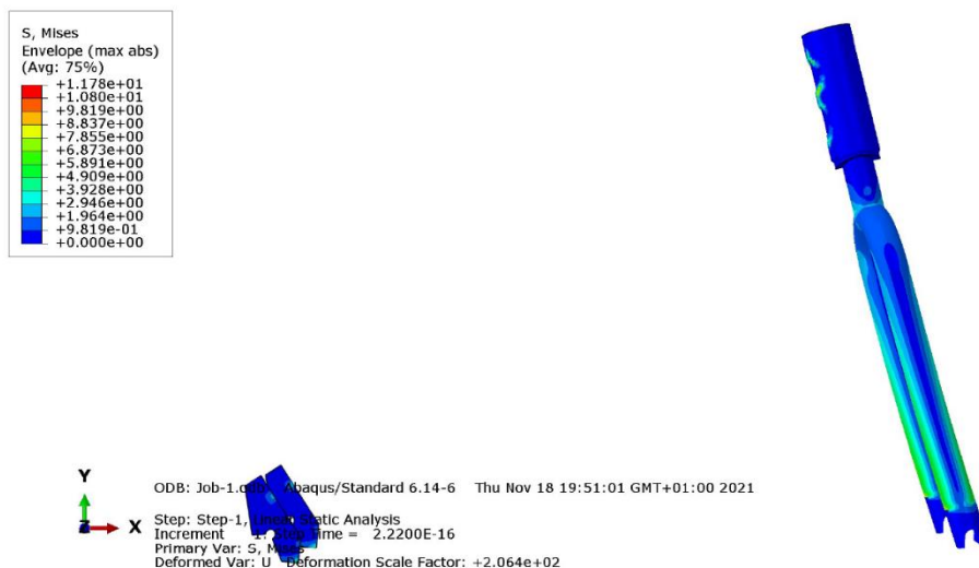
Figura 62. Distribución de tensiones de Von Mises acero, en MPa, Abaqus.
