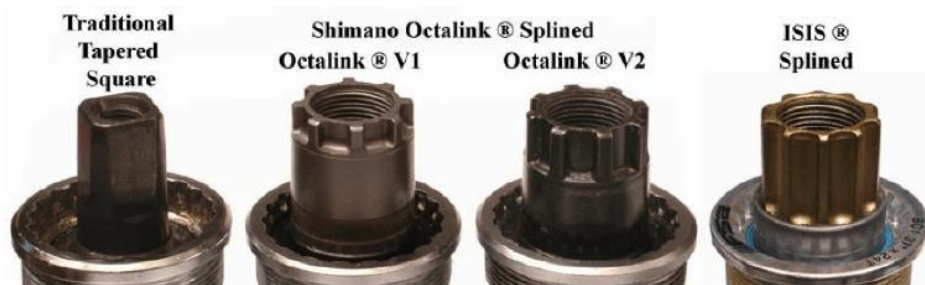
Figura 20. Tipos de ejes pedalier [9].
