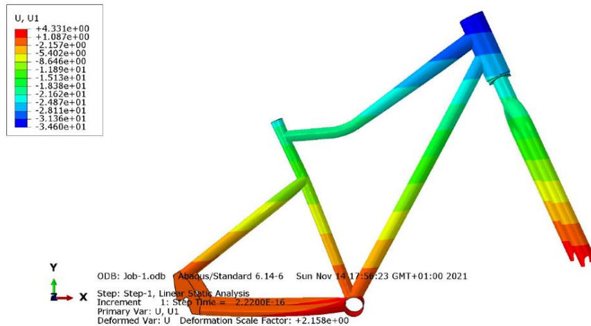
Figura 65. Distribución de desplazamientos en X, Step 2, en mm, Abaqus.
