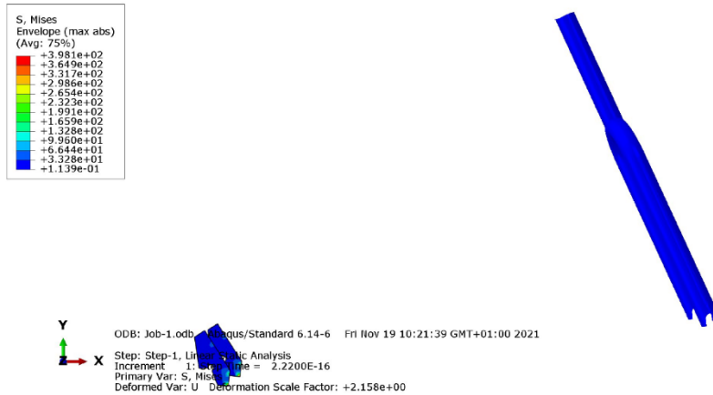
Figura 66. Distribución de tensiones de Von Mises, Step 2, acero, en MPa, Abaqus.
