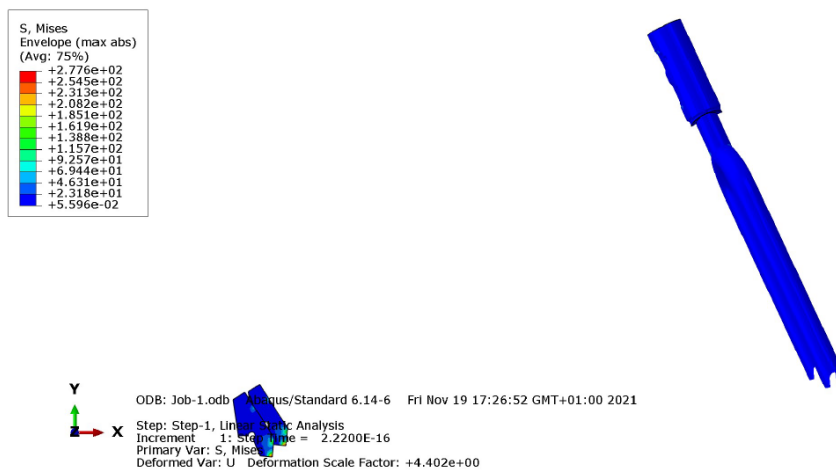
Figura 83. Distribución de tensiones de Von Mises, Step 2, acero, en MPa, Abaqus.
