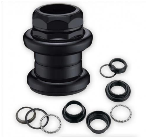
Figura 12. Dirección roscada (threaded) [4].
