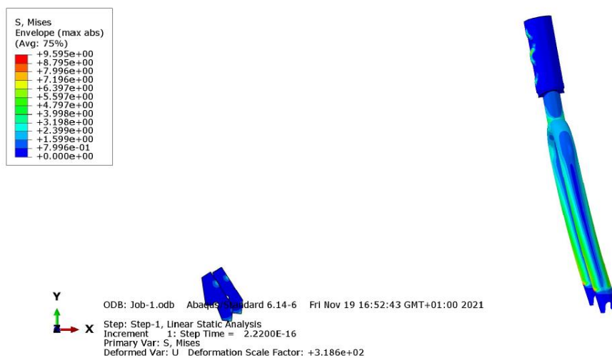
Figura 85. Distribución de tensiones de Von Mises acero, en MPa, Abaqus.
