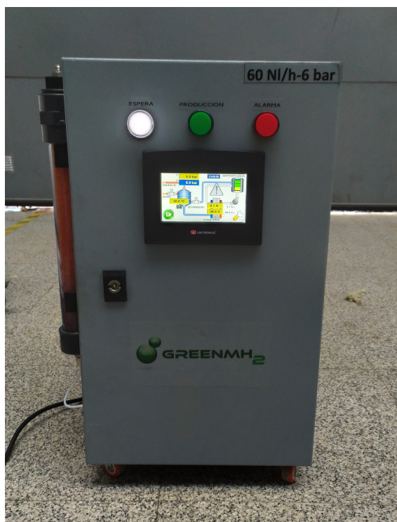
Figura 2.2: Electrolizador PEM modelo Hart de GREEN MH 2 empleado para el presente Proyecto.
