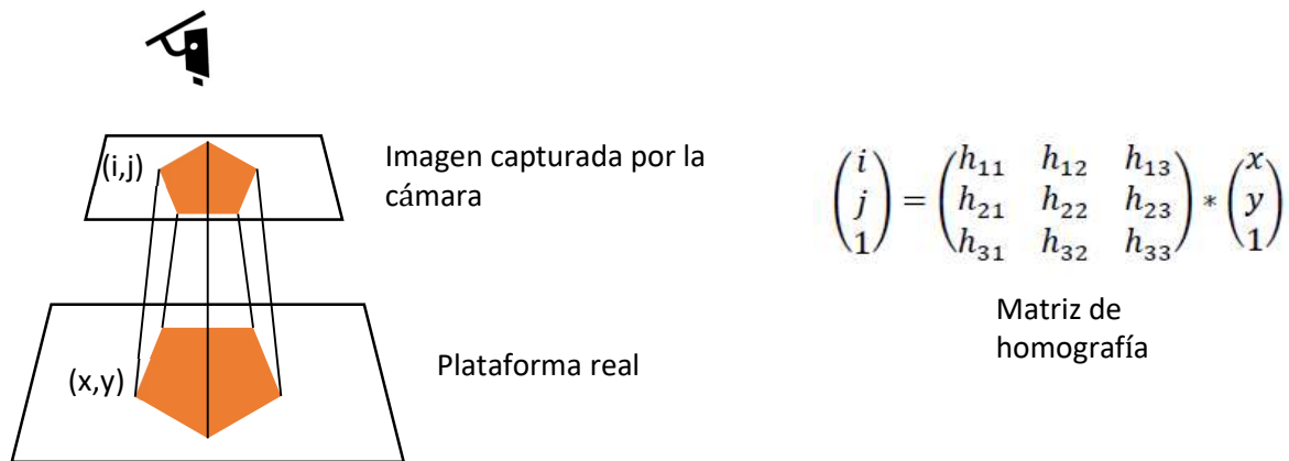
Figura 16. Conversión de puntos del mundo real a la imagen capturada por la cámara.
