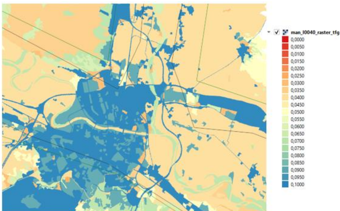
Figura A.1.3.4. Capa con ráster de Manning generada. A la izquierda, leyenda con sus valores correspondientes por color.
