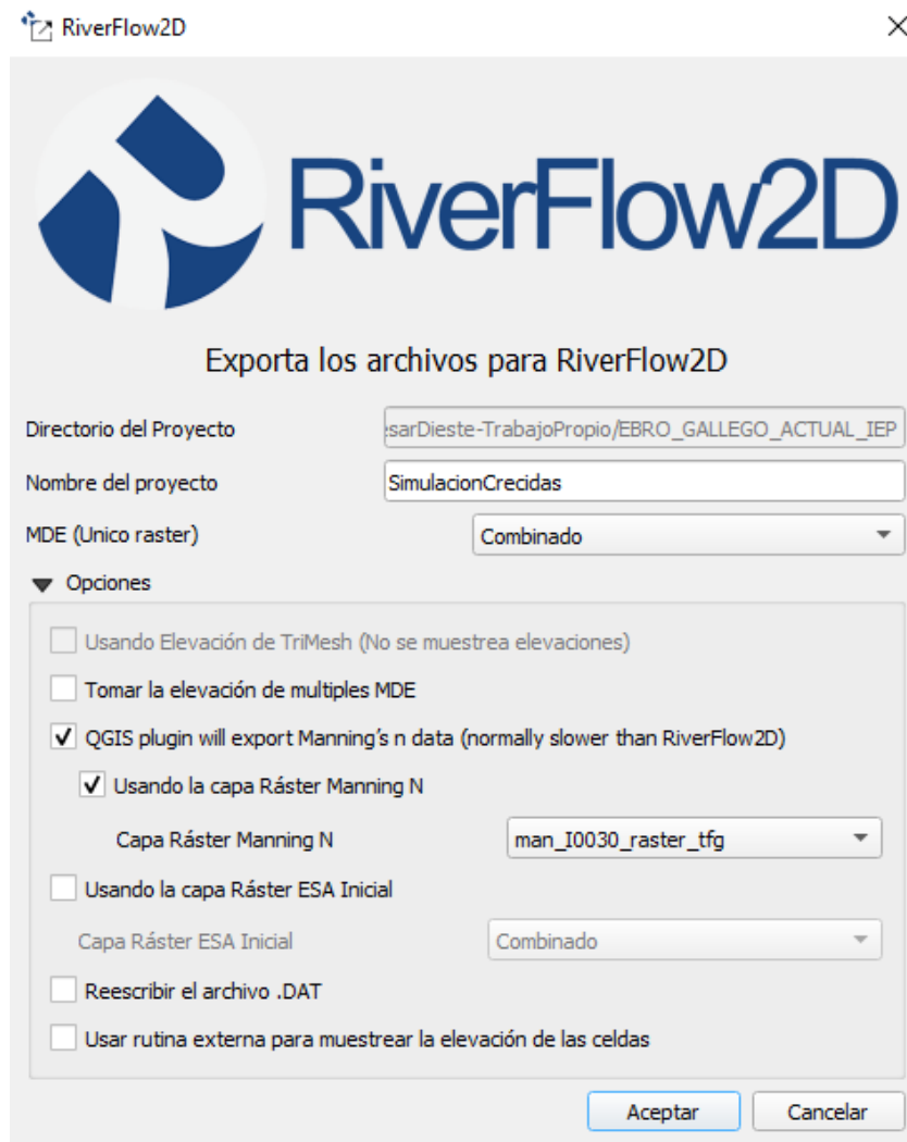
Figura A.1.5.2. Ventana de QGIS previa a la exportación de datos a RiverFlow2D.
