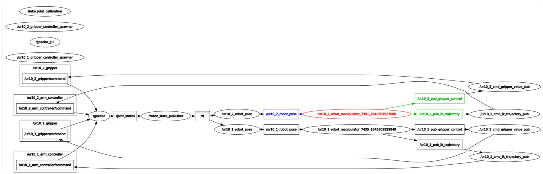
Figura C.22: Fase 3: Nodos y topics del planificador propio para dos cobots
