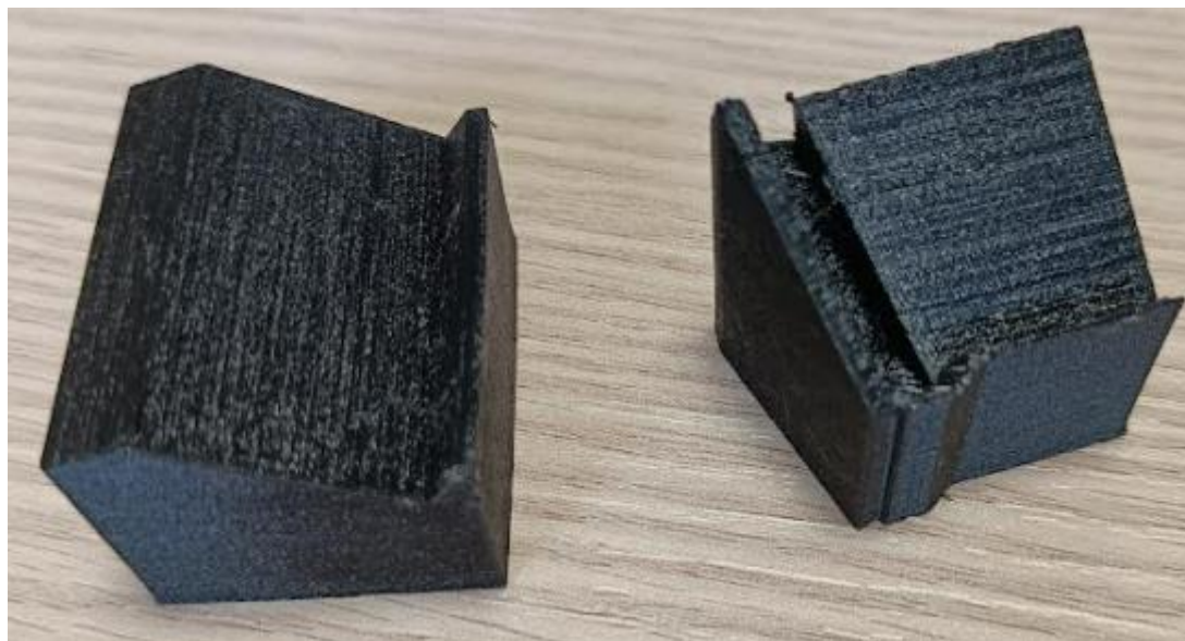
Figura 5.2 Piezas TC y TL1.1 a escala reducida con material semiflex negro.
