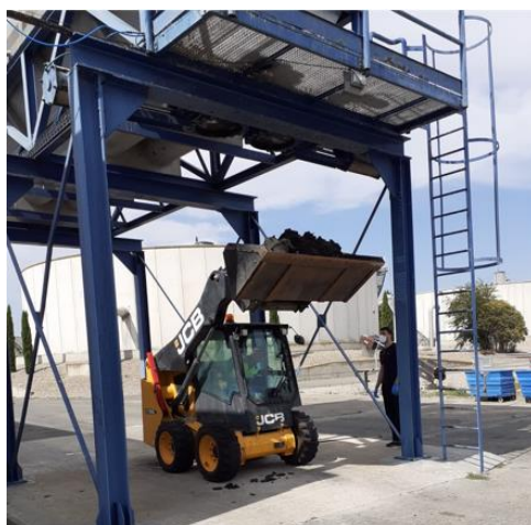
Ilustración 9. Extracción de fango deshidratado
