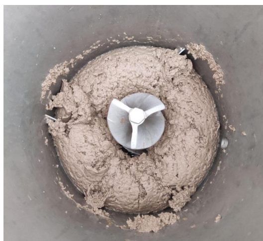
Figura 4. Pasta húmeda de papel recuperado en el pulper con un 10% de fibra.
