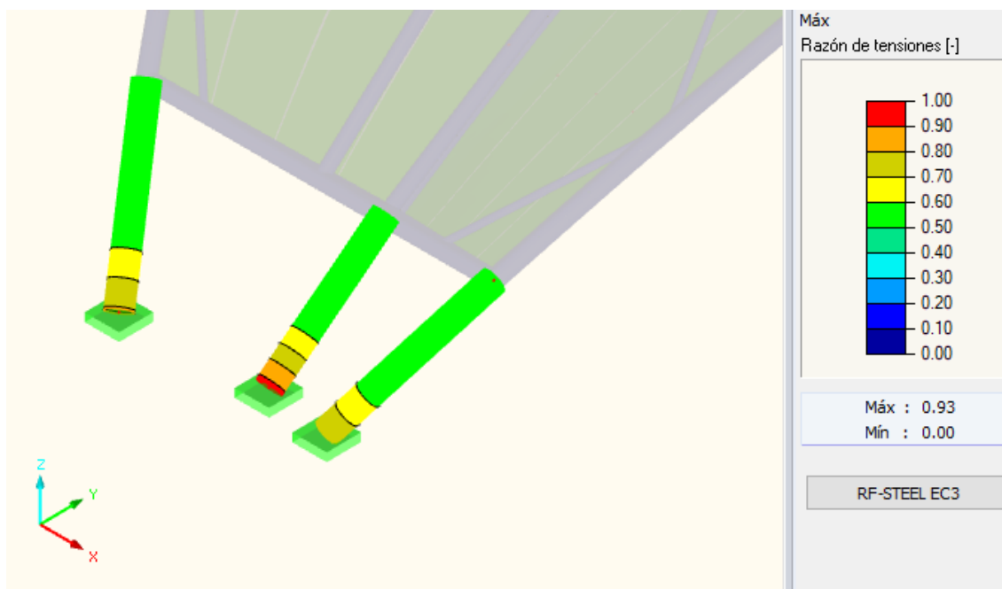
Figura 37. Razón de tensiones de resistencia mostrada por RFEM para las barras de apoyo.
