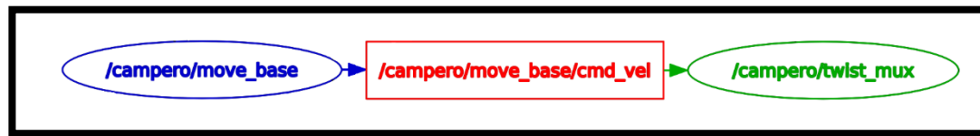
Figura 5: Ejemplo comunicación nodos. Rqt-graph comando ROS
