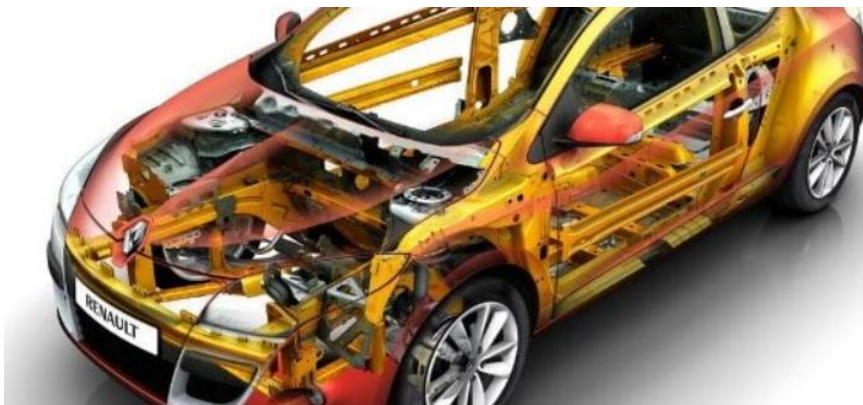
Figura 3.1.1 Estructura interna del vehículo encargada de absorber energía en caso de impacto [4].
