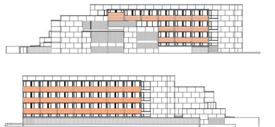
Ilustración 24: Esquema ubicación fachada ALUCOBOND. Fuente: Elaboración propia
