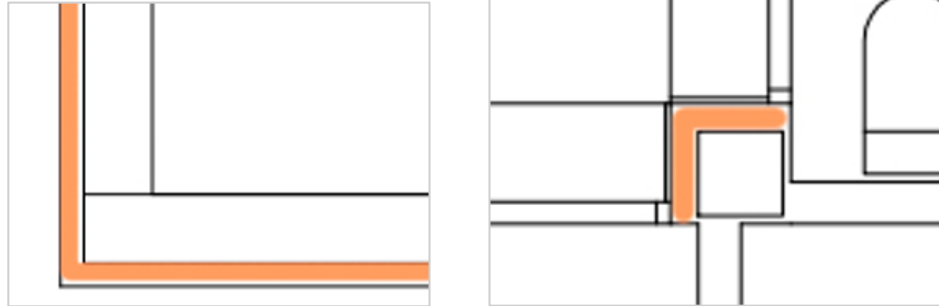
Ilustración 82: Puentes térmicos producidos por las esquinas o encuentros de fachada.
