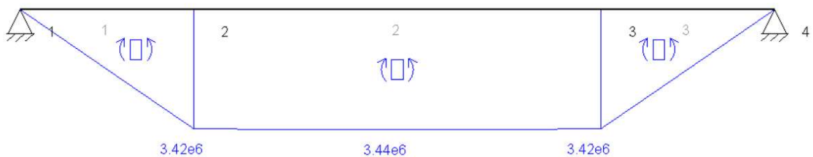
Ilustración 16. Diagrama de momentos flectores de las vigas transversales con el vehículo centrado
