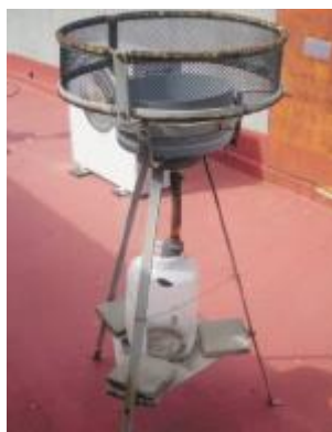
Figura 1 - Captador de muestras contaminantes manual de la RED de Vigilancia de Madrid (1968)
