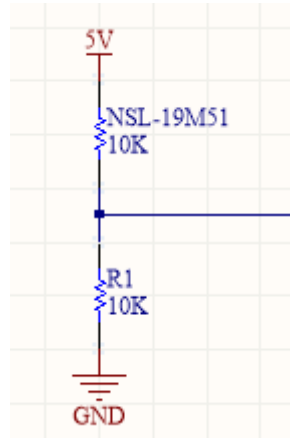
Figura 21 - Esquemático subsistema lumínico, luz visible
