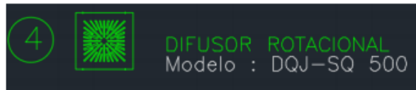
Ilustración 42. Difusor rotacional en sala de estudios.
