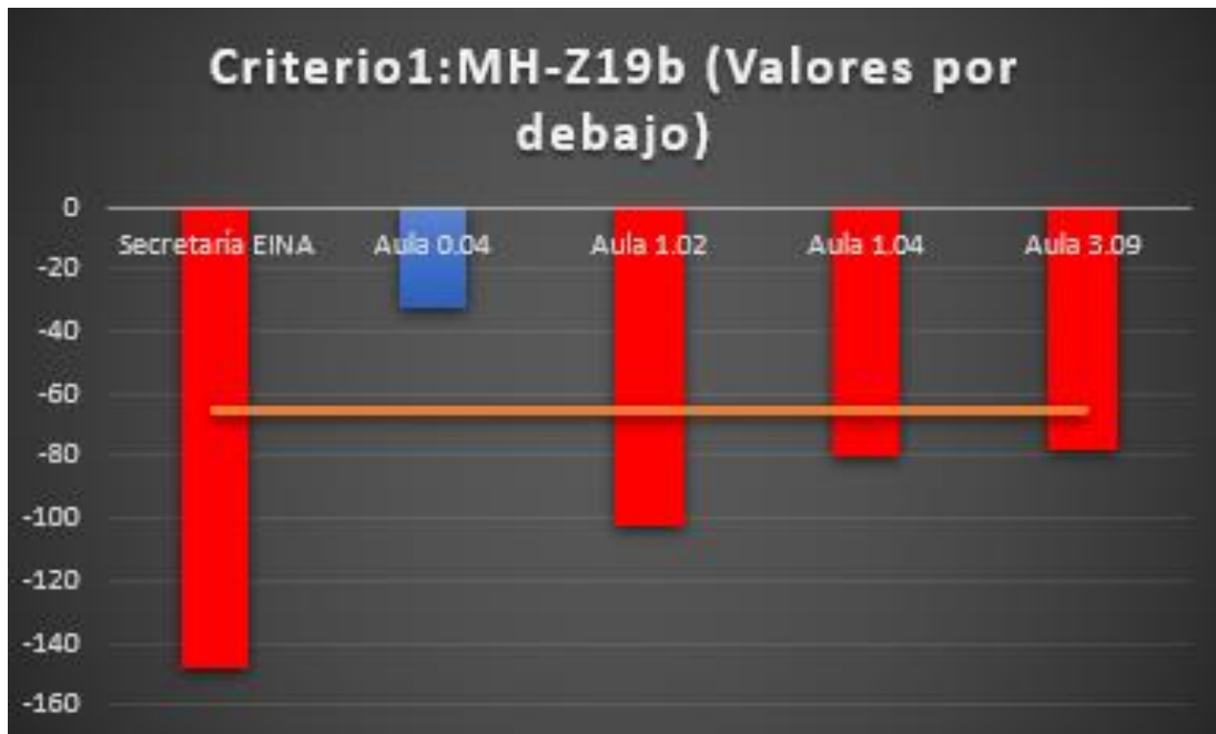
Criterio1 aplicado a valores del sensor MH-Z19b que se encontraban por encima de los obtenidos con Aranet4 Pro
