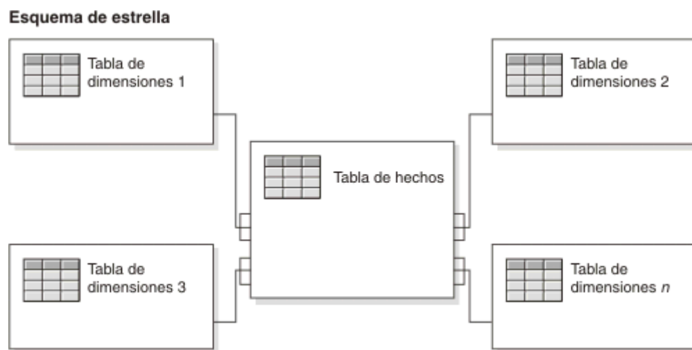
Figura 1: Esquema de estrella con una sola tabla de hechos con enlaces a varias tablas de dimensiones [4].
