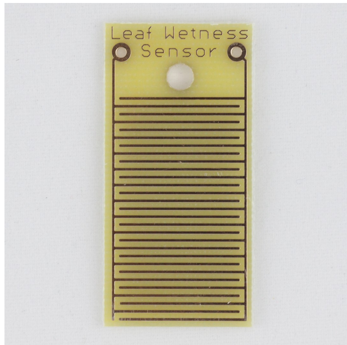
Figura 19: Sensor resistivo de humectación de hoja
