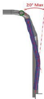
Figura 10. Refuerzo del pilar de la ventanilla [2].
