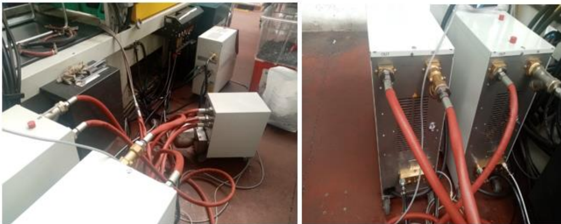
Fig 52. Conexiones de las unidades de control de temperatura con la unidad de conmutación y esto a su vez con el molde (izquierda) y unidades de control de temperatura (derecha). Fuente: Elaboración propia.
