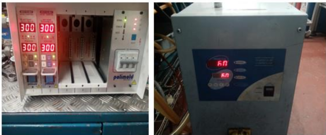
Fig 40. Temperatura de la cámara (izquierda) y temperatura del molde (derecha). Fuente: Elaboración propia.
