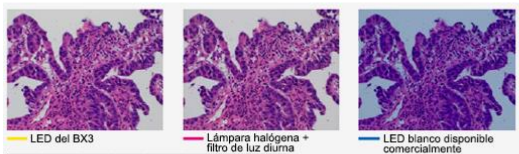
Fig 68. Comparativa de la luz LED utilizada en el microscopio frente a la utilizada comercialmente. Fuente: tomado de [27].
