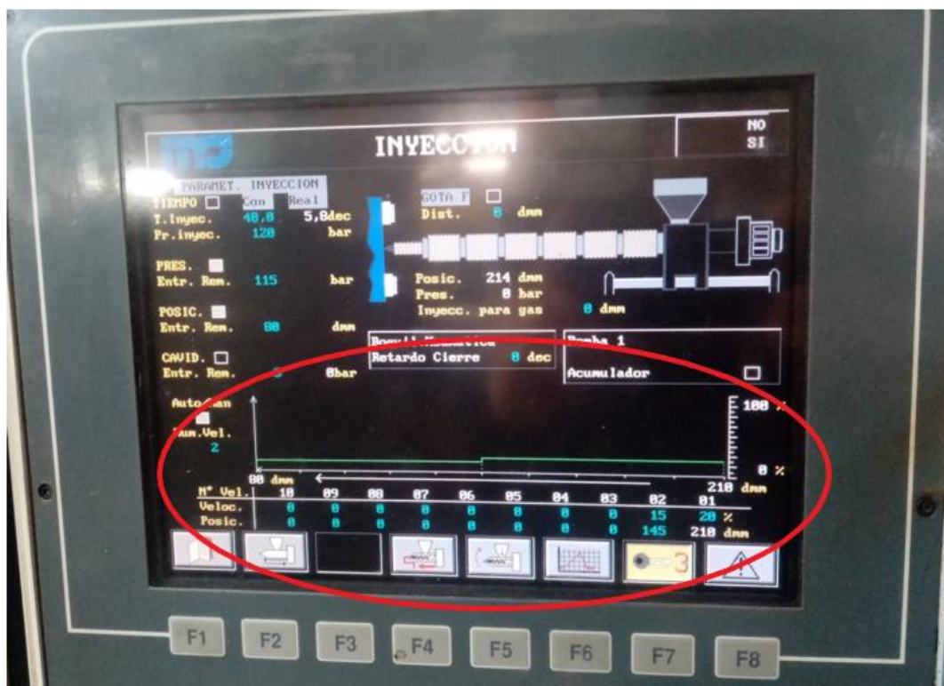
Fig 38. Perfil de velocidades programado en la máquina de inyección. Fuente: Elaboración propia.
