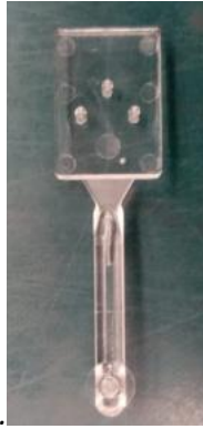
Fig 41. Pieza inyectada sin segunda presión. Fuente: Elaboración propia.
