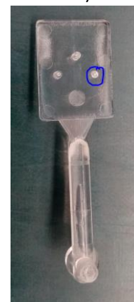
Fig 43. Pieza inyectada con 50 bar de segunda presión. Fuente: Elaboración propia.
