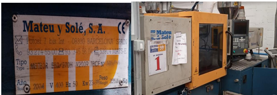
Fig 26. Máquina de inyección utilizada (derecha) y placa de características de la máquina (izquierda).
