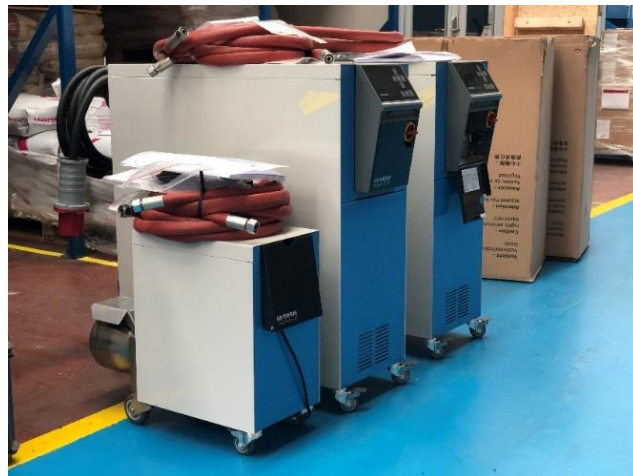
Fig 9. Sistema Variotherm utilizado en las pruebas de molde. Fuente: Elaboración propia.
