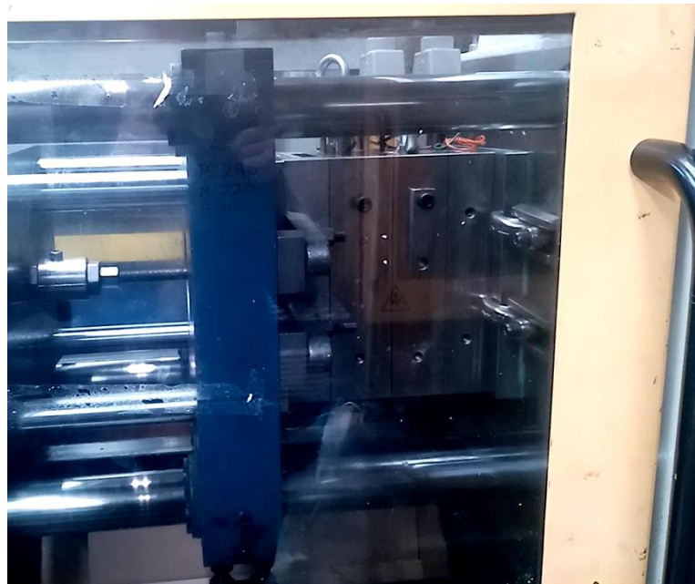
Fig 28. Molde PACHINKO montado en máquina.
