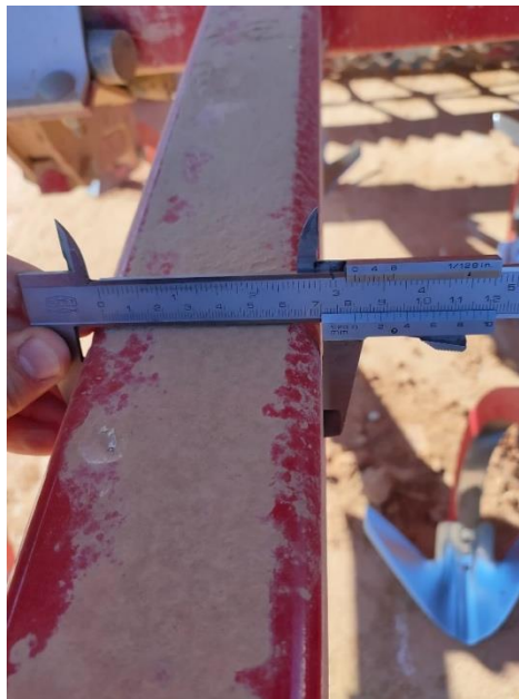
Ilustración 24. Medición cara horizontal del bastidor.
