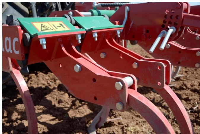
Ilustración 26. Sistema comercial de sujeción del brazo.
