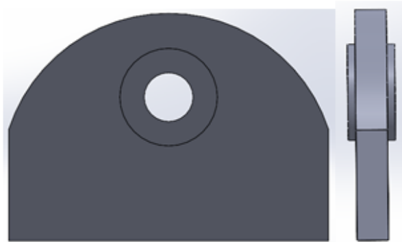
Ilustración 144. Alzado y perfil del refuerzo aplicado en la orejeta.
