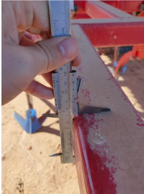
Ilustración 25. Medición cara vertical del bastidor.
