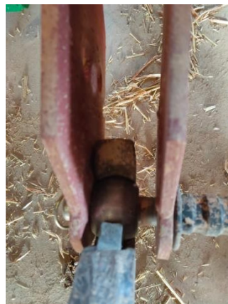
Ilustración 180. Conexión entre enganche del aplicador y la cisterna.
