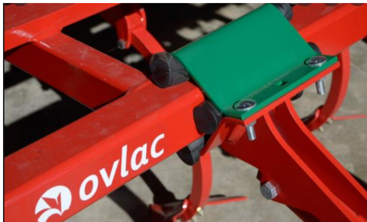
Ilustración 47. Detalle de los elastómeros.
