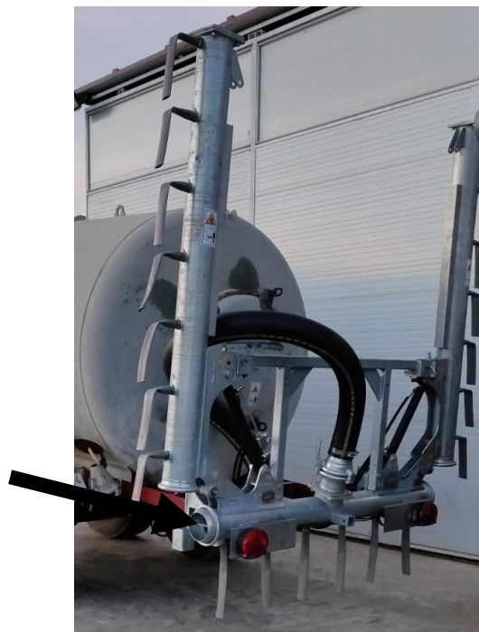
Ilustración 21. Sistema de filtraje sobre cada una de las salidas de purín.
