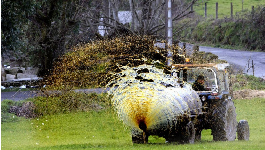
Ilustración 4. Reparto de estiércol mediante plato o abanico.
