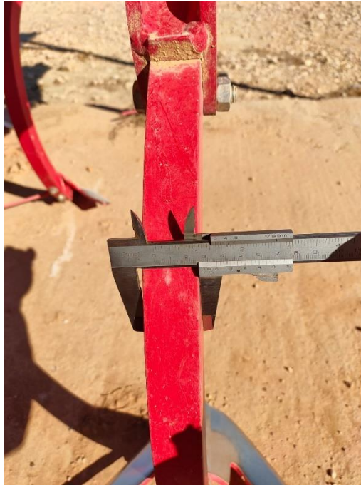
Ilustración 27. Medición sobre la cara horizontal del brazo.
