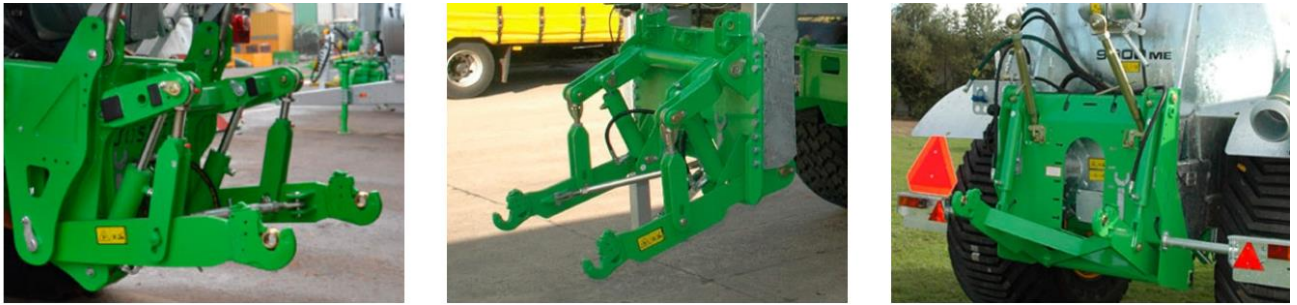
Ilustración 23. Sistema de enganche cuba-aplicador/inyector.
