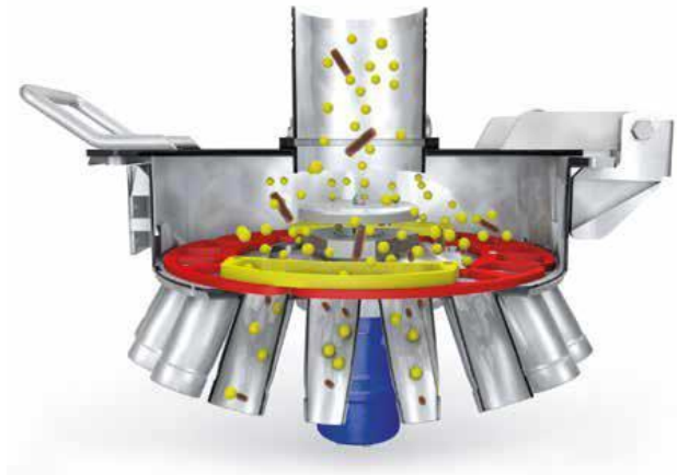
Ilustración 17. Corte de sección del distribuidor de purín.
