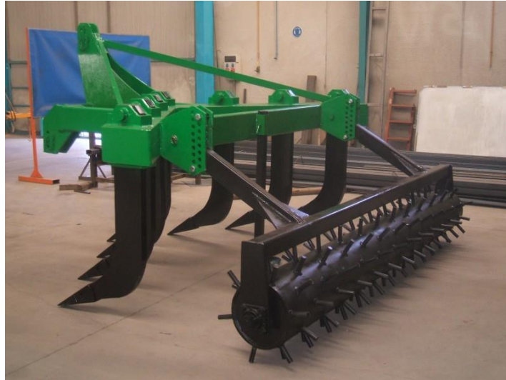
Ilustración 8. Sistema de brazo rígido, para labores en terrenos con una gran compactación.
