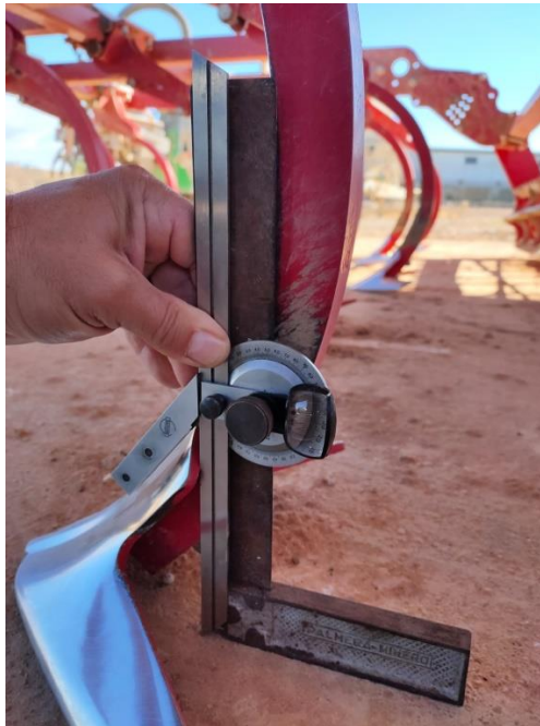
Ilustración 31. Medición del ángulo de incidencia sobre la vertical.
