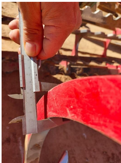
Ilustración 28. Medición sobre la cara vertical del brazo.
