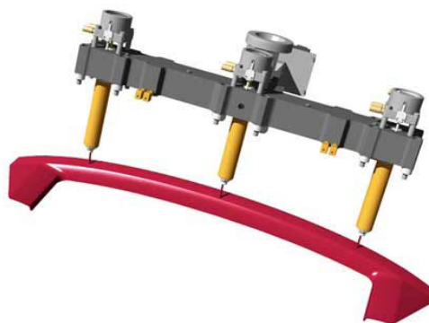
Fig 1.5.2 Inyección secuencial de la piel de un parachoques [F6]
