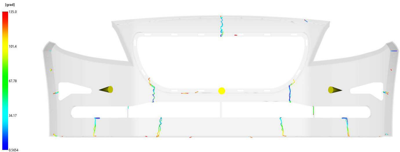
Fig 9.1.2.6 Tres puntos de inyección interior
