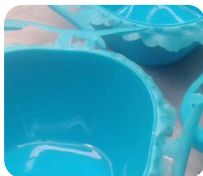
Fig 1.4 Defectos en piezas inyectadas [F4]
