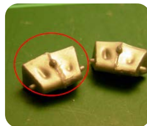
Fig 1.4 Defectos en piezas inyectadas [F4]
