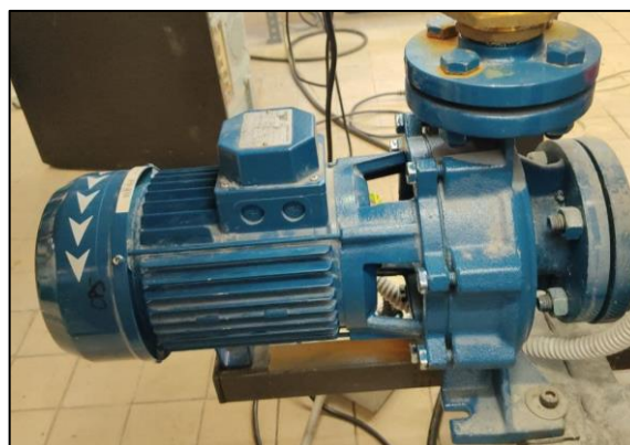
Figura 7. Bomba Centrífuga Normalizada CM 32-160 A.
