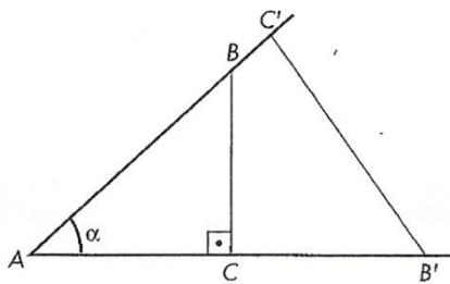
*Si sobre un ángulo,  $\alpha$ , se construyen dos triángulos rectángulos distintos,  $ABC$  y  $AB'C'$ , se obtienen dos valores para  $\operatorname{sen}\alpha$ :*
