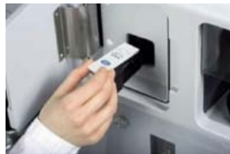
Figura 23. Apt a) chip Serie S CM5. Apt b) Introducción del chip en el instrumento de Resonancia de Plasmón Superficial (SPR).
