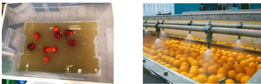
Figura 14. Tratamiento postcosecha mediante inmersión de nectarinas (izquierda) en un formulado líquido de B. velezensis BUZ-14 y duchado de naranjas con el fungicida imazalil (derecha).
