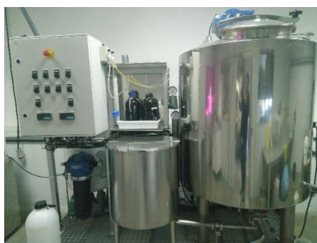
Figura 12. Bioreactor para el crecimiento de microorganismos antagonistas y desarrollo de formulados líquidos de biocontrol
