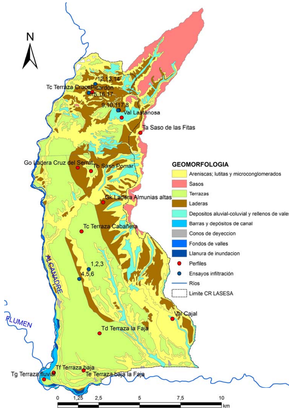
Figura 4.1. Mapa Geomorfológico de LASESA según ITGE y ubicación de perfiles y ensayos de infiltración.
