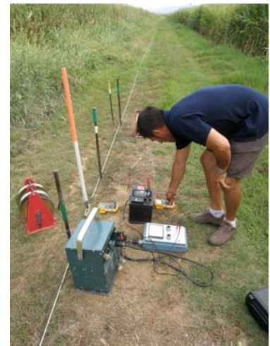
Figura 4.12. Esquema de la medición de resistividad por el método de cuatro electrodos.
