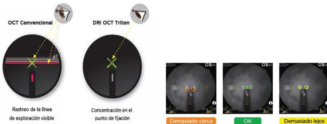
Figura 14. DRI-Triton SS-OCT visualización del punto de fijación y alineación. Tomada de [Topcon, 2015].
