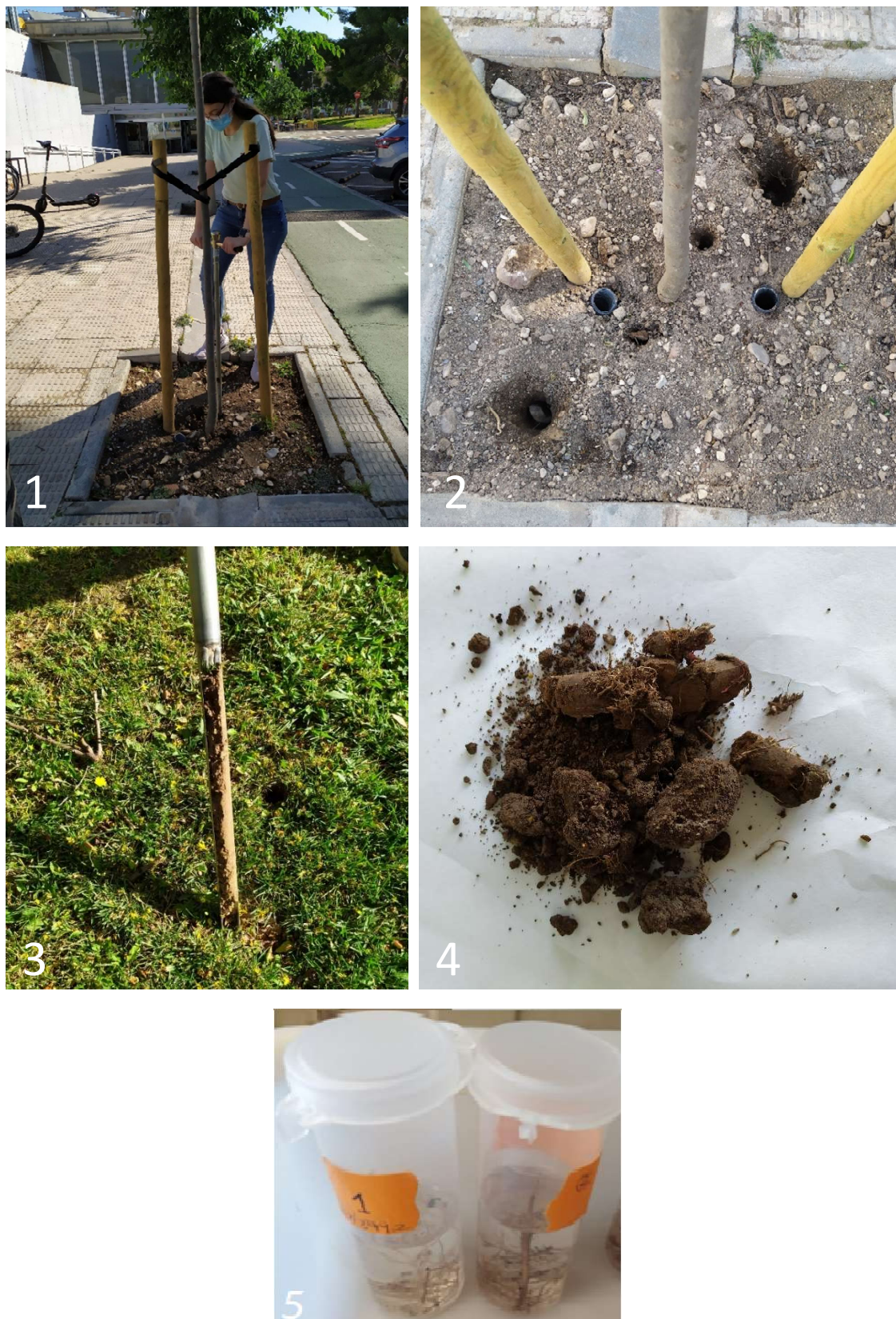
Figura 6. Toma de muestras para la determinación del estado de micorrización en raíces. 1. Muestreo con barrena de caña cilíndrica en alcorque; 2. Árbol muestreado; 3. Barrena de caña cilíndrica con muestra; 4. Suelo y raíces; 5. Raíces conservadas en etanol.
