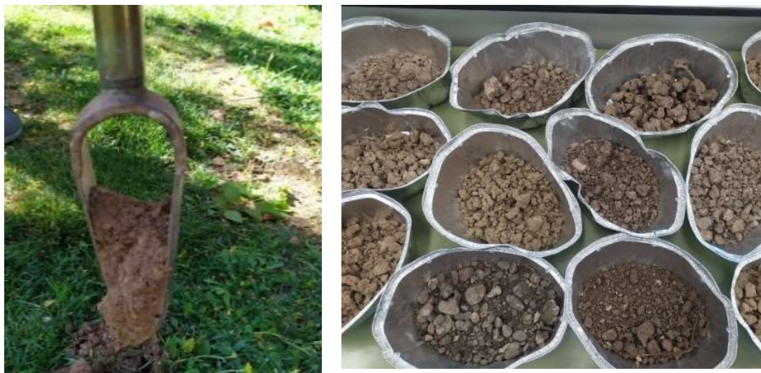
Figura 7. Barrena y muestras de suelo obtenidas para realizar el análisis fisicoquímico, calcular el número de esporas de HMA y determinar el potencial micorrícico de la zona.
