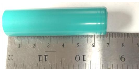
Ilustración 7. Batería IRN 18650-20R [18]
