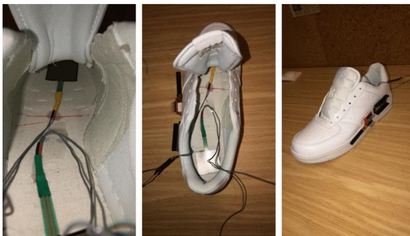
Figura 2. Prototipo de zapato capaz de reconocer gestos de emergencia.[3]
