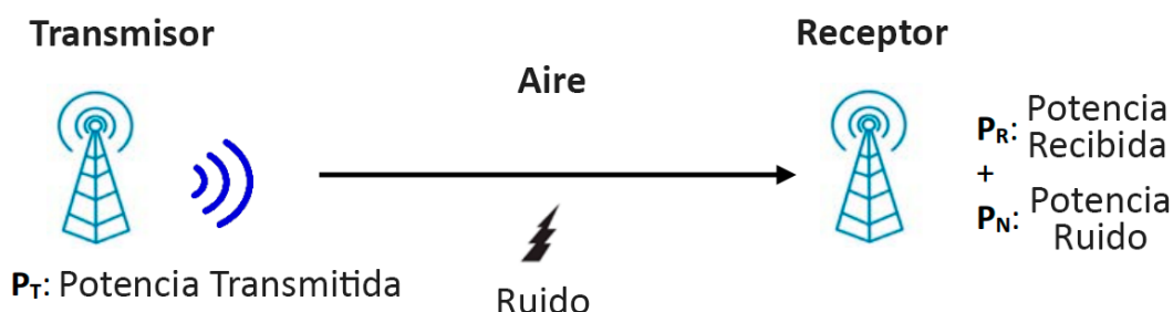
Figura 13. Transmisión de radio frecuencia.[19]
