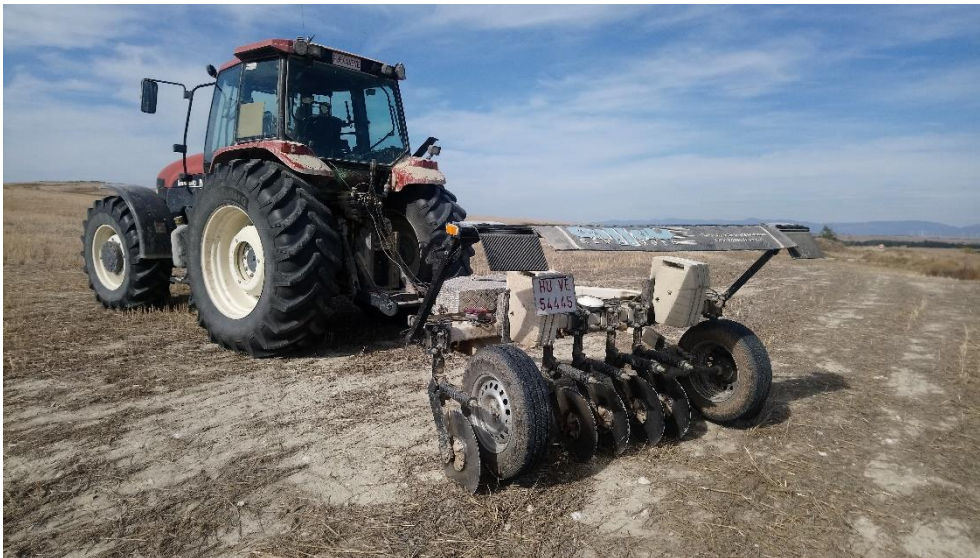
Figura 15: Muestreo con el sensor VERIS 3100 en la parcela experimental 2 de Valsalada. Foto: M. Videgain.
