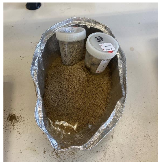
Figura 22: Bandeja metálica con la muestra de tierra tamizada, y separados los elementos gruesos.
