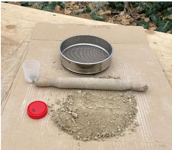
Figura 21: Procesado de las muestras para la determinación de elementos gruesos.
