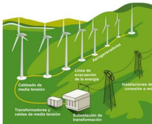
Figura 7. Esquema de un parque eólico. Fuente: [12].
