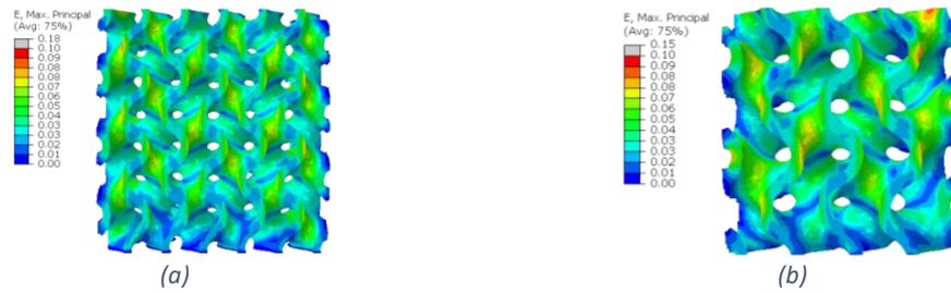
Figura 20. Deformaciones del andamio con estructura giroidea para distintos tamaños de celda unitaria, (a) 10 mm, (b) 15 mm
