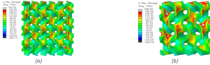
Figura 19. Tensiones principales máximas (MPa) del andamio con estructura giroidea para distintos tamaños de celda unitaria, (a) 10 mm, (b) 15 mm
