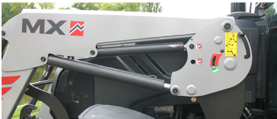
Fig.5: Cargador frontal MX con sistema de auto nivelación hidráulico (PCH System).
