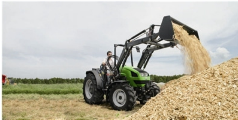
Fig.3: Cargador frontal Deutz Fahr modelo L8, sistema de autonivelación con cuadrilátero en el interior del chasis principal.
